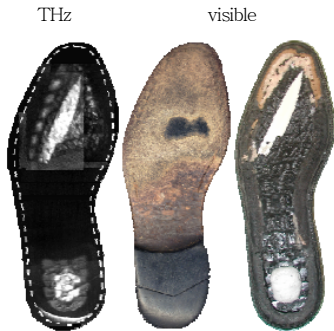
(그림 9) 구두창 밑에 숨긴 세라믹 흉기를 THz 영상으로 감지한 경우. 일반 x-ray로는 감지할 수 없다.
