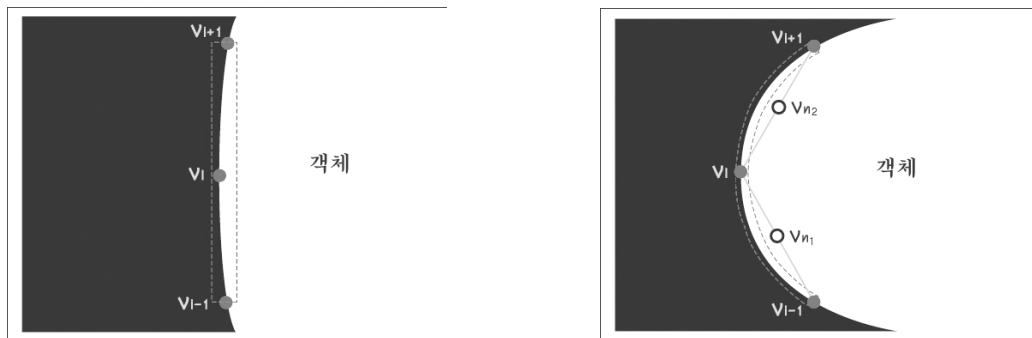
(a) 낮은 곡률 (b) 높은 곡률 (그림 1) 객체 윤곽의 곡률 값 및 새로운 스네이크 포인트( v_{n_1}, v_{n_2} ) 삽입
