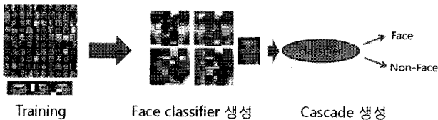
그림 2 얼굴 데이터베이스를 이용한 직렬 구조 생성 Fig. 2 Cascading creation using face databases
