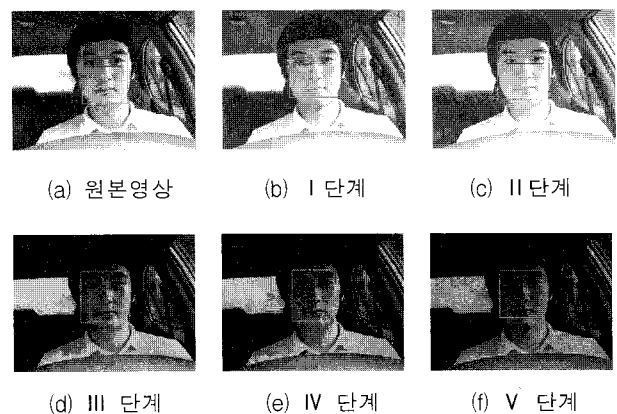
그림 5 조명변화에 따른 얼굴 및 눈 영역 추출 Fig. 5 Extraction of face eye region for illumination changing
