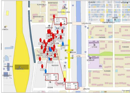
(그림 4) A-GPS 단말의 위치정보 획득 결과 (실내 고정, 3m 이격)
