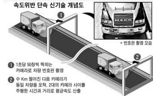
〈그림 5〉 호주의 구간단속시스템 개념도
