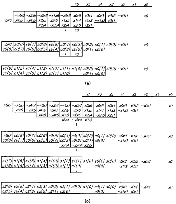
그림 1. 제곱기의 부분곱을 Wallace 트리 방식을 이용하여 더하는 과정: (a) 입력 워드길이 = 7, (b) 입력 워드길이 = 8 (s : sum, c : carry).
