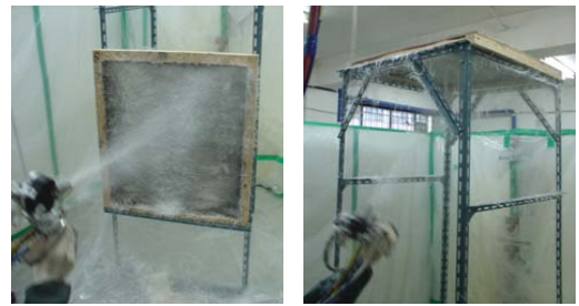
(a) 측면 분사 실험 (b) 천정면 분사 실험 Fig. 6 반발률 실험
