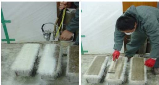
(a) 분사 과정 (b) 롤링 과정 Fig. 3 휨 시편에 대한 분사식 FRP의 적용
