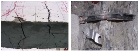
(a) 바닥면 파괴형상 (b) FRP-Rod 파괴형상 Fig. 9 FRP-Rod 보강보의 파괴형상
