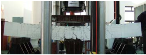
(b) 압축축을 구속한 FRP 보강 콘크리트의 압축파괴
