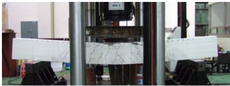
(a) FRP 보강 콘크리트의 압축파괴
