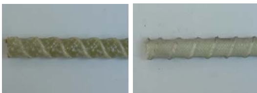
(a) Type 1 (b) Type 2 Fig. 3 FRP 보강근의 형상
