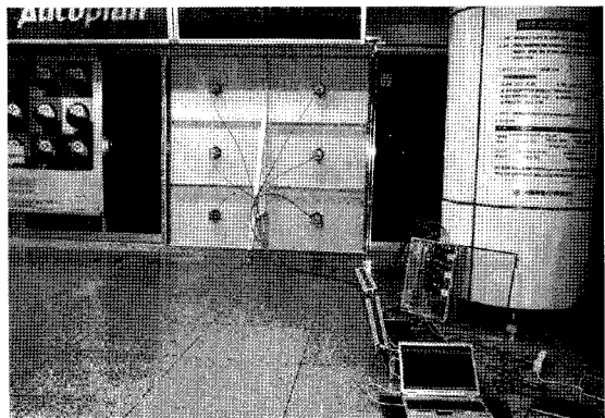
[그림 5] 스크린도어 열차풍압 측정
