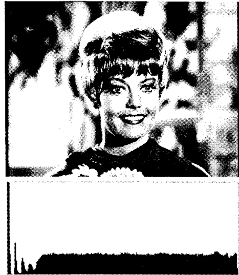
그림 13 히스토그램 평활화 기법을 적용한 영상 Fig. 13 Histogram equalized image
