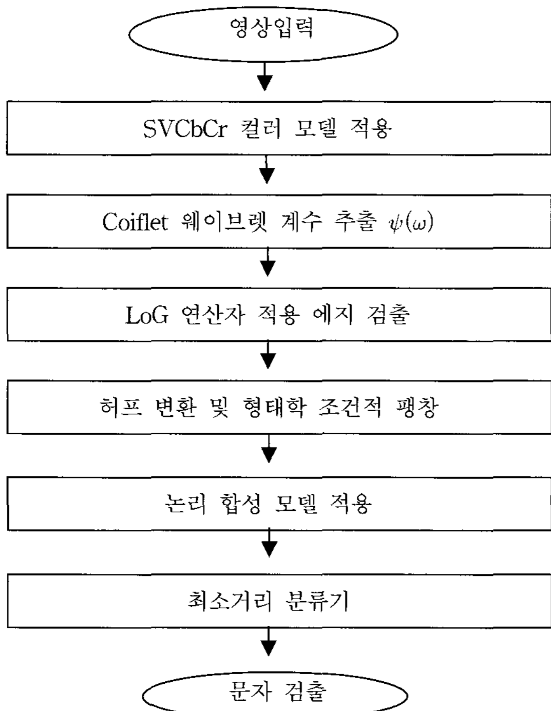
그림 12. 제안된 문자 검출 알고리즘의 흐름도 Fig. 1. Flowchart of the proposal multi characters detection algorithm
