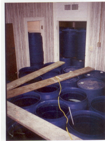
그림 2. 물통을 사용하여 재하시험을 하는 모습 (사용중인 건물에 대해 전통적인 24시간 단조하중 재하시험 방법을 수행하는 것은 비용이 많이 들고 불편함)
