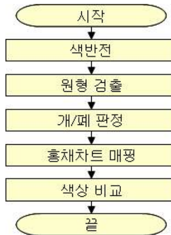
그림 7. 얼공 검출 알고리즘 Fig 7. Lacunals Extraction Algorithm
