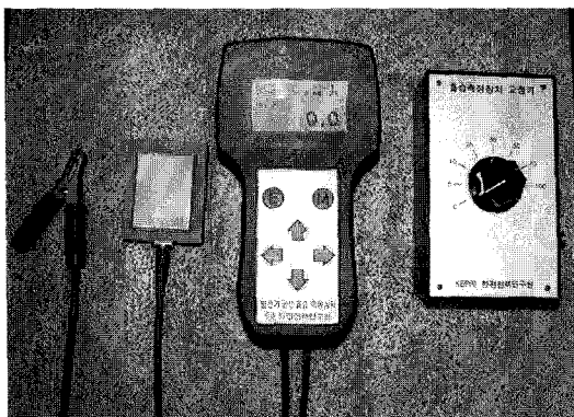
그림 2 흡습 시험장치(Gen-SWAD) Fig. 2 Generator stator water absorption detector
