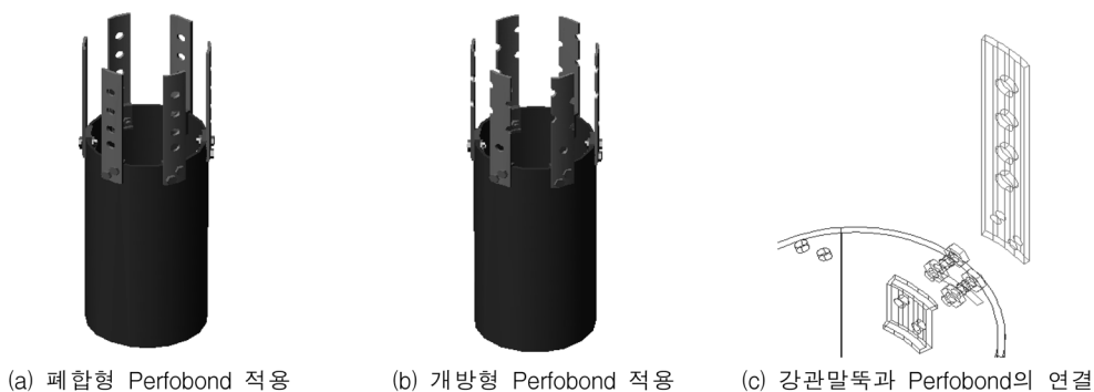
그림 1. 유공강관 전단연결재를 활용한 강관말뚝머리 보강방법
