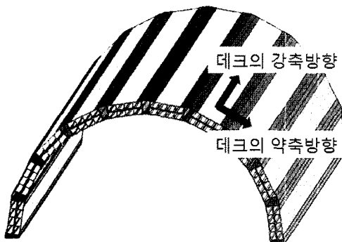
그림 9 완성된 복층구조 약축방향결합 아치구조
