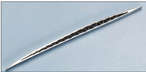
(a) Hollow Wide Chord Fan Blade
