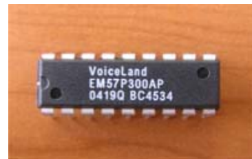
(그림 4) 녹음 및 재생방식의 IC 칩 예
