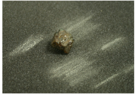
[그림 5] #11시편과 SiC연마지의 스크래치 실험. 다이아몬드는 마모되지 않고 연마지만 훼손되어 연마흔을 남겼다.
