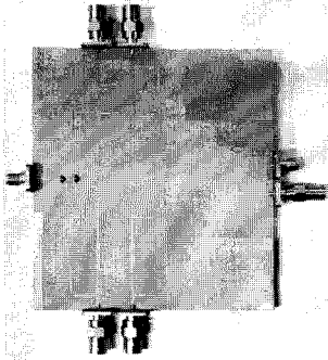
그림 7. 제작된 six-port 위상 상관기 Fig. 7. Fabricated six-port phase correlator
