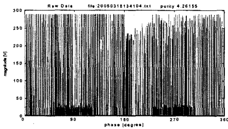
(a) 잡음제거 이전의 부분방전 신호 패턴 (a) Before noise rejection
