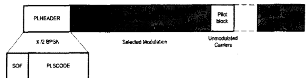
그림 1. DVB-S2 물리계층 프레임 구조 Fig. 1. Structure of DVB-S2 Physical Layer Frame.
