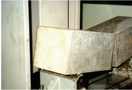
Fig. 6 신구 콘크리트 계면의 파괴양상
