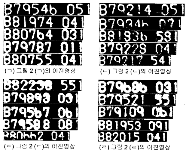
그림 7 전처리과정의 결과(그림 2의 이진영상) Fig. 7 Result of pre-processing (binary image of Fig. 2)
