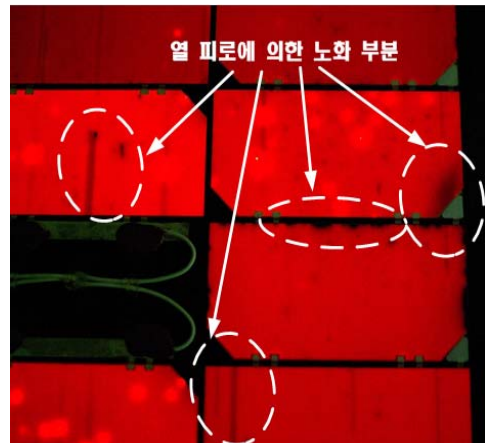
그림 16. 열 피로에 의한 노화 결함 (EMCORE ATJ CIC 태양전지)
