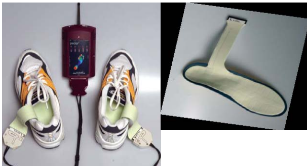
그림 1. 족압 측정 장치(좌: Pedar-x System; 우: Insole) [source: http://www.novel.de ]
