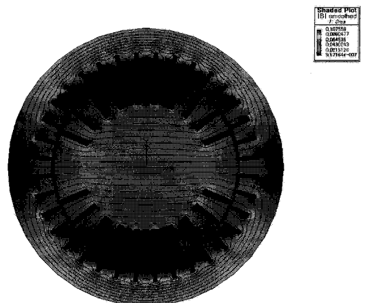
그림 3 정자장 자장해석 결과 Fig. 3 Simulation result of static magnetic field analysis
