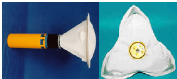
Fig. 2. 발사체 및 삼각 Ballute 형상
