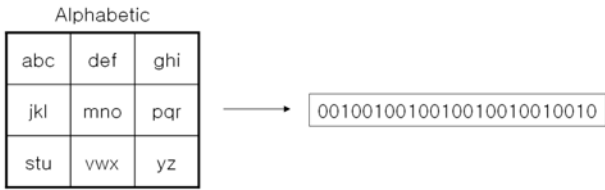
그림 3. 알파벳 순서를 유지한 키패드 디자인의 염색체 표현 Fig. 3. Representation for keypad designs with alphabetical constraints
