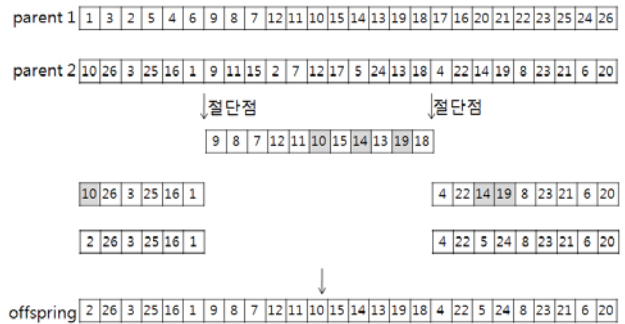
그림 6. PMX 교차 연산의 예 Fig. 6. An example of PMX crossover
