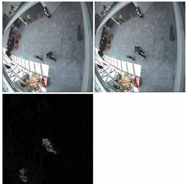
그림 2. 차 영상을 이용한 움직임 벡터 검출. Fig. 2. Detection of motion vector using Difference image
