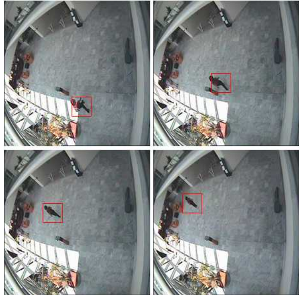
그림 8. 히스토그램과 위치 정보를 이용한 움직이는 물체 추적 결과 Fig. 8. Experiment of Object Tracking using Both Histogram and Position information
