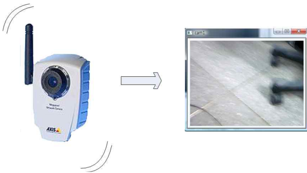
그림 1. 진동에 의한 불안정 영상 Fig. 1. Unstable image by vibration
