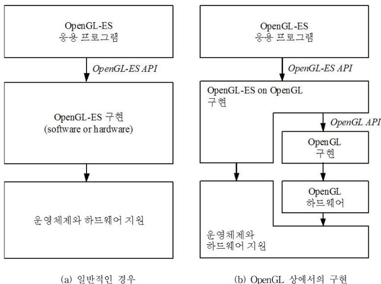
(그림 2) OpenGL ES의 구현 (a) 일반적인 경우 (b) OpenGL 상에서의 구현
