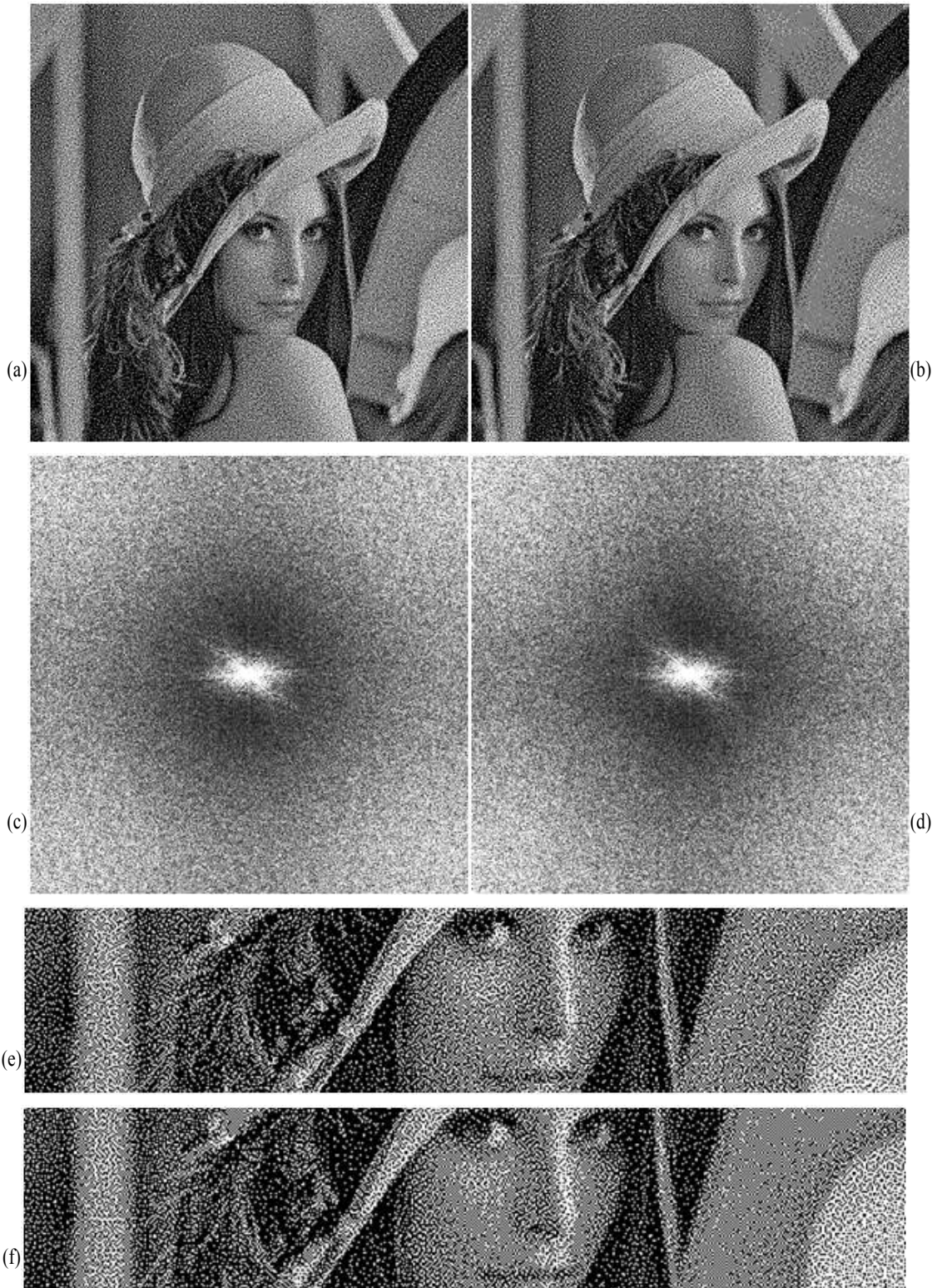
그림 2. Lena 영상에 대한 실험 결과 비교 (a)(c)(e)제안한 방법의 결과 (b)(d)(f) SFC 알고리즘의 결과 (c)(d) 영상의 FFT 변환
