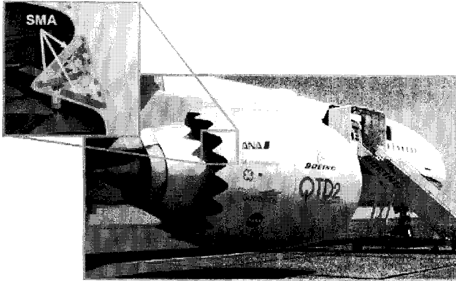
그림 4 형상기억합금 작동기를 이용한 active chevrons
