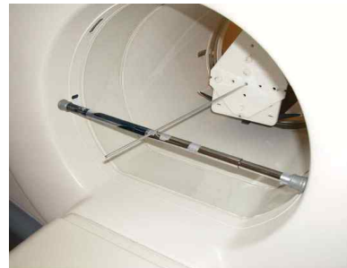
그림 5. Spring Tensioned Rod 설치
