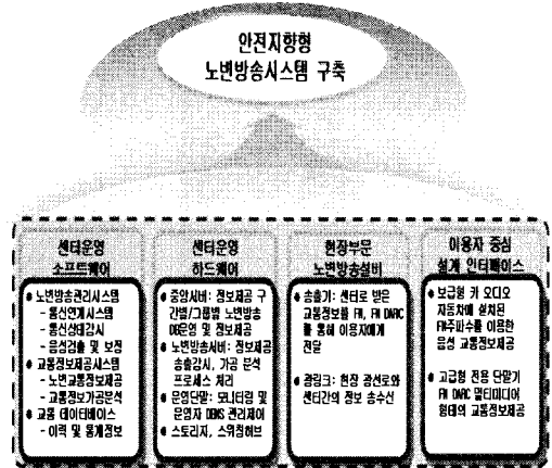
그림 2. 노변방송시스템의 구축 Fig. 2. Implementation of HAR system
