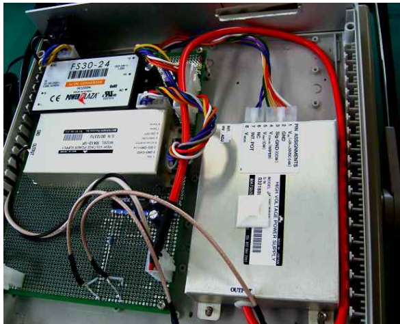
그림 11. 가변형 파형 발생 회로 Fig 11. variable pulse generating circuit
