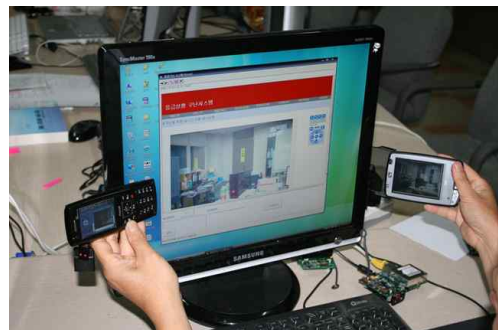
그림 9. 실시간 감지된 상황을 PDA/Mobile Phone으로 동시 전송 Fig. 9. Real-time detected a PDA / Mobile Phone to the simultaneous transmission
