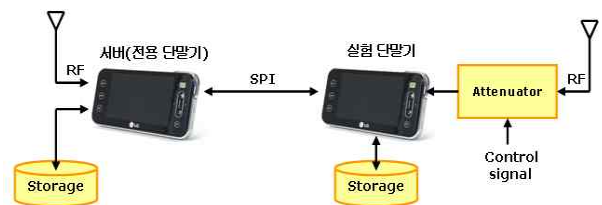
그림 6. 전체 실험 시스템의 구성 Fig. 6. Configuration of the testing system
