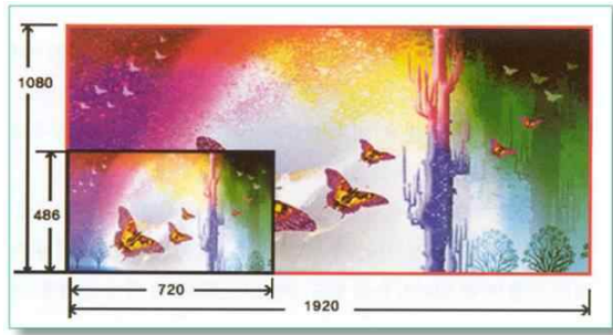
그림 1. SDTV와 HDTV 화면크기 비교 Fig 1. Comparison of aspect ratios for SDTV and HDTV
