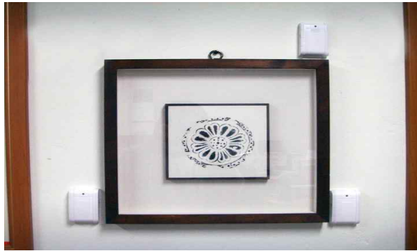
그림 8. RFID 및 센서노드의 전시물 주변 장착 Fig. 8. RFID and sensor node setting of exhibition
