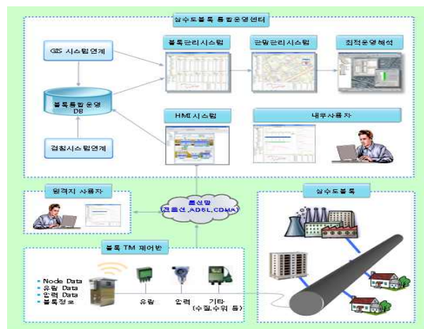
그림 2. 상수도 블록 감시제어시스템 Fig. 2. Block monitoring and control system
