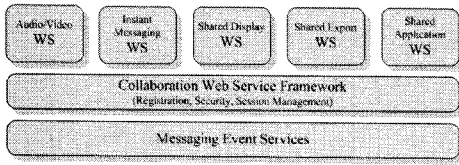
그림 1. Global MMCS 아키텍처 구조 Fig. 1. Global MMCS architecture
