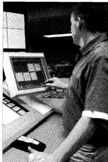
그림 13 비전시스템을 이용한 레지스터 마크의 측정 (22)
