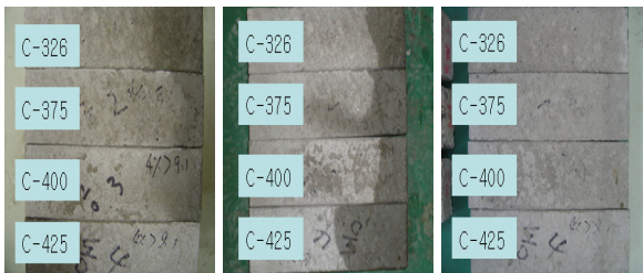
(a) 30 Cycle (b) 120 Cycle (c) 300 Cycle 그림 12. 공기량 3% 이상 시험체의 각 사이클 별 시험체 형상 (수돗물 사용)
