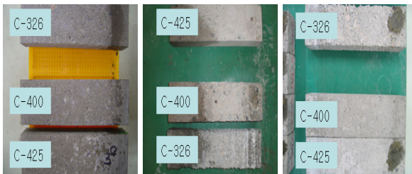
(a) 30 Cycle (b) 120 Cycle (c) 300 Cycle 그림 13. 공기량 3% 이상 시험체의 각 사이클 별 시험체 형상 (NaCl 4% 용액 사용)
