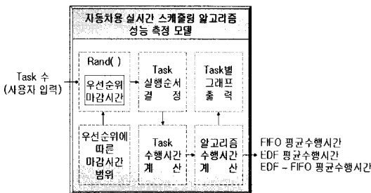
그림 6. '자동차용 실시간 스케줄링 알고리즘 성능 측정 모델' 동작 과정 Fig. 6 Performance Evaluation Model for Automobile Real-Time Scheduling Algorithm
