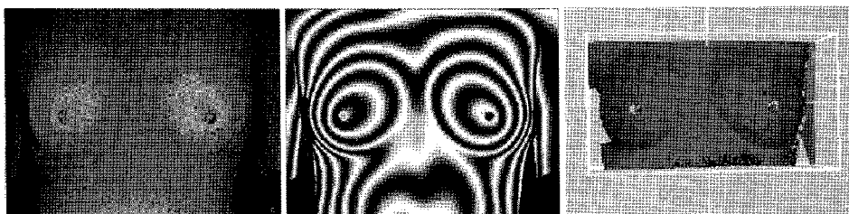
(a) scan 상태 (b) 무아레 무늬 (c) 3차원 형상
