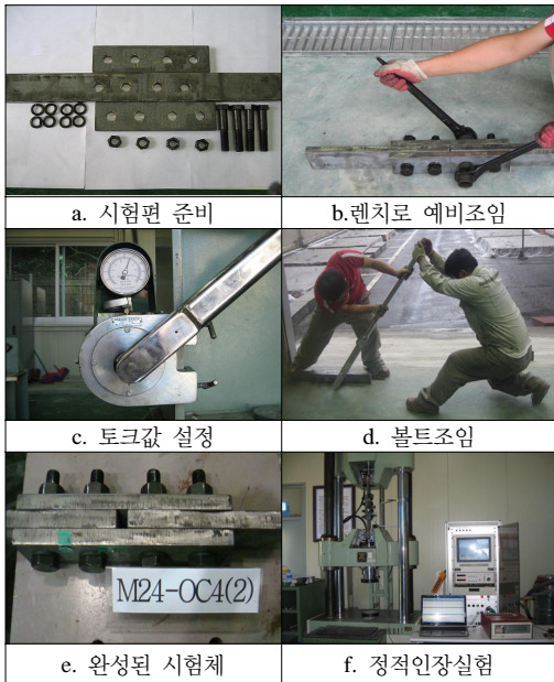
[그림 4] 시험편의 제작 및 조립
