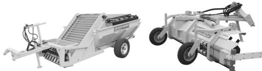
계사 청소기 전문회사 이천종합농업기계(대표 김정식)가 가금류실청소기와 하우스키퍼 그레이더를 선보인다. 가금류실청소기는 젖은 바닥에 까는 왕겨, 톱밥, 계분 등을 깨끗하고 간편하게 제거하는 기계로 남은 깔짚에 신속하게 공기를 쐬어 암모니아 가스배출과 건조시간을 최소화시켜준다고 전한다. 또한 하우스키퍼 그레이더는 계사 모서리나 가장자리에 남아 있는 계분을 처리하는 기계로 구석구석을 청소하는데 도움을 준다고 전한다. 한 대의 기계로 계사관리가 용이해 경제성과 편리함을 동시에 볼 수 있을 것으로 보여진다.
